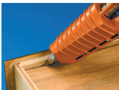
Aby wytłumić spody szuflad, skorzystaj z kleju termotopliwego 3M™ Hot Melt 3792.
