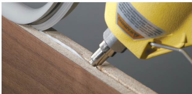
Klejenie listwy krawędziowej z tworzywa sztucznego w rowek wyfrezowany w desce.
