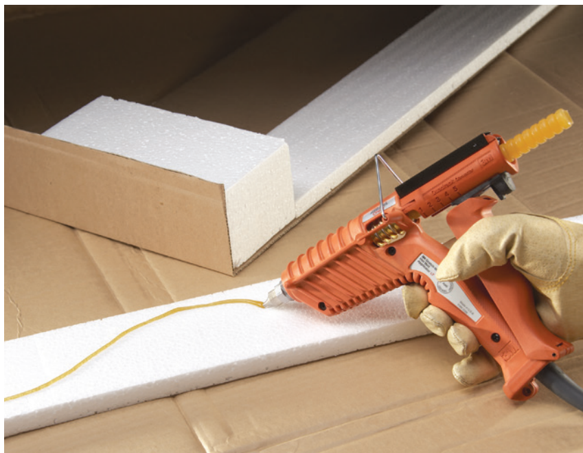
Aplikator 3M™ Hot Melt Applicator LT i klej termotopliwy 3M™ Hot Melt 3762LM, aplikowany w niskiej temperaturze 129°C jest idealny do klejenia materiałów wrażliwych na działanie wysokich temperatur, jak np. pianki styropianowej, tektury i innych powierzchni - bez najmniejszej szkody dla klejonego materiału.
