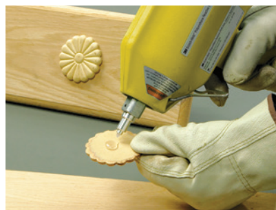
Klejenie drewnianych lub plastikowych ozdób do drewnianych drzwiczek w szafkach.
