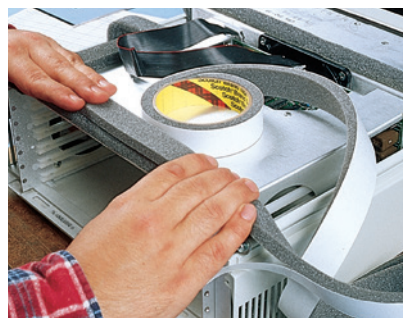
Po ściśnięciu do 50% objętości, otwarte komórki taśmy poliuretanowej 3M™ zapewniają barierę powietrzną i amortyzację w sprzęcie elektronicznym.
