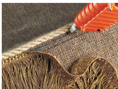
Aplikator 3M™ Hot Melt LT oraz klej termotopliwy 3M™ Hot Melt 3792LM pozwalają na aplikację w niskiej temperaturze 129°C i przyspieszają proces paslowania, szuperowania, usztywniania i łączenia tkanin z drewnem.
