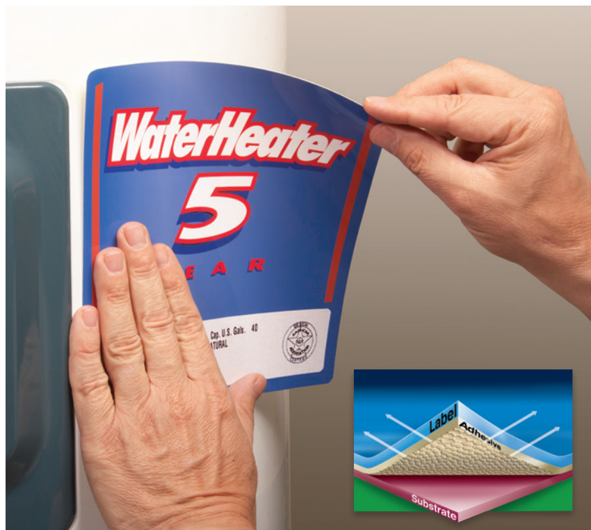
Materiały etykietowe 3M™ — Dzięki unikalnej technologii wytwarzania mikrokanatów w kleju, powietrze swobodnie przepływa między klejem etykiety a podłożem. Etykiety aplikowane ręcznie nareszcie mogą być montowane bez marszczenia i bąbli powietrza.
