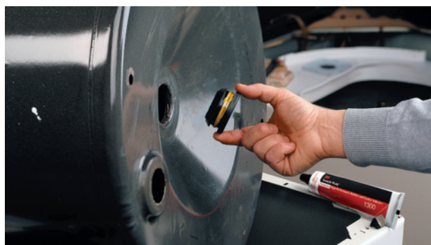
W procesie napraw pralek neoprenowy klej 3M™ High Performance 1300 do klejenia uszczelek i tworzyw gumowych uszczelnia i natychmiastowo przytwierdza pierścień uszczelniający w obudowie bębna pralki.
