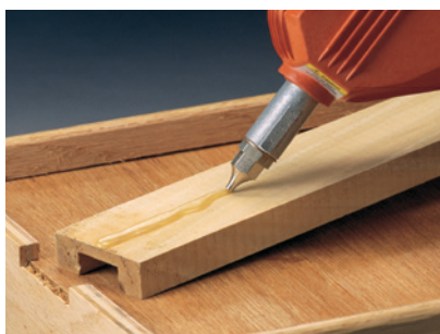
Klejenie przewodnic do spódów szuflad. Klej termotopliwy 3M™ Hot Melt 3792 zapewnia bardzo mocne połączenie.
