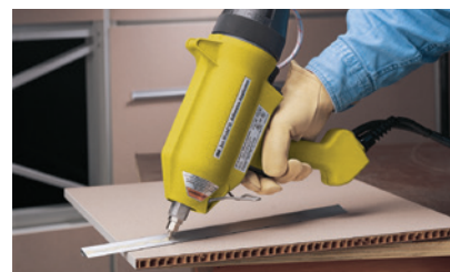
Klejenie łączonego aluminium do laminatu w celu ukrycia struktury komórkowej pod warstwą aluminium
