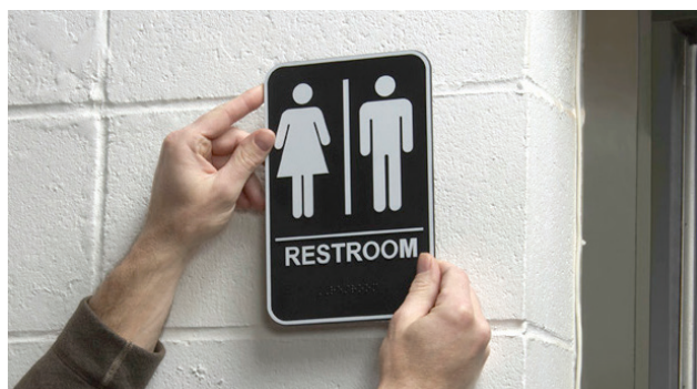
Dwustronne, poliuretanowe taśmy piankowe 3M™ umożliwiają klejenie tabliczek informacyjnych z tworzywa sztucznego do pomalowanej ściany. Pianka wypełnia szczeliny pomiędzy nieregularnymi powierzchniami. Szeroki wybór grubości pianki zapewnia możliwość kompensacji różnego stopnia chropowatości powierzchni.
