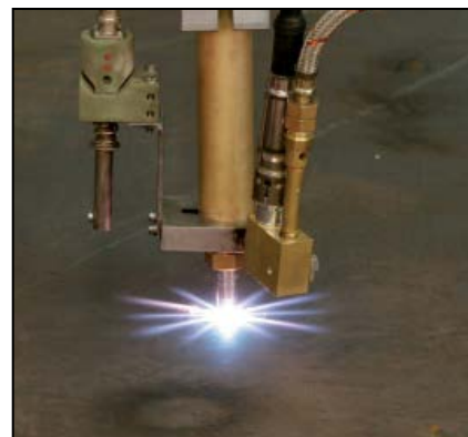
Wstępne podgrzewanie z FIT™
