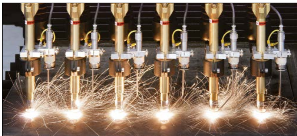
BIR+™ multi-palnik do przebijania otworów
